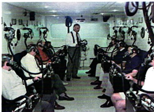
Cámara de altitud. También llamada cámara hipobárica, puede simular diferentes niveles de altitud, presión barométrica y de hipoxia. (Fuente: NASA.)
