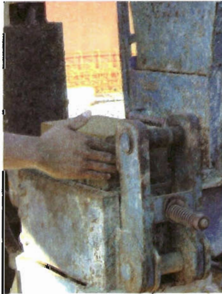
Foto 21. Proceso de fabricación de los BTC
