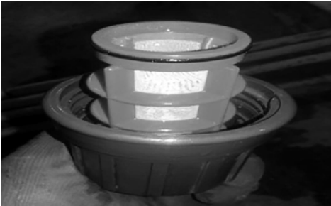
Figura 6.5. Filtro de malla
