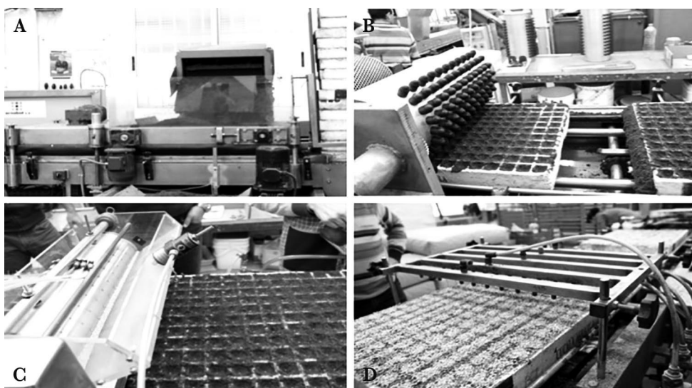
Figura 3.9. Proceso de siembra automatizada. A) desmenuzado y llenado de bandejas. B) punzonado sobre el sustrato. C) siembra. D) cubrimiento de la semilla y humectación del sustrato
