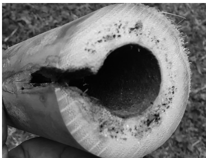
Figuras 16. Sección transversal de probeta, puede observarse el deterioro iniciado por ataque de insectos o por picoteo de algunas aves, debe ser desechado. Fuente: Autor.
