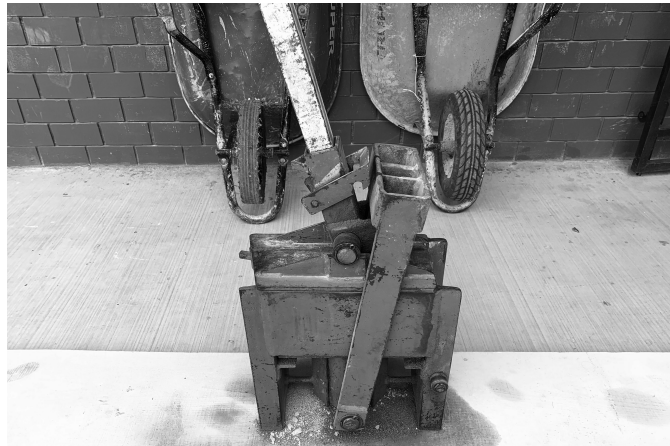
Figura X. CinvaRam, prensa de tierra para fabricar Bloques de Tierra Comprimida, utilizada en la FADU-UAT para las prácticas académicas. Fotografía: J. A. Espuna
