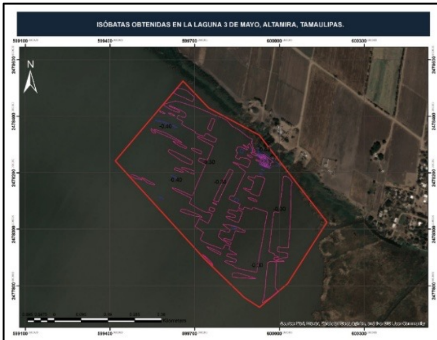
Figura 4. Isóbatas obtenidas por medio del estudio batimétrico en Laguna 3 de Mayo Fuente: elaboración propia.
