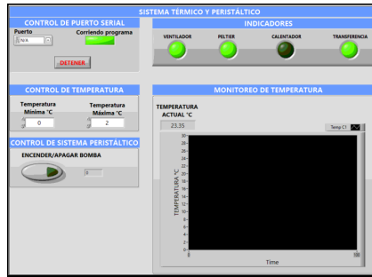
Figura 13. GUI empleada para la prueba 5 en el modo de operación enfriamiento Fuente: elaboración propia.
