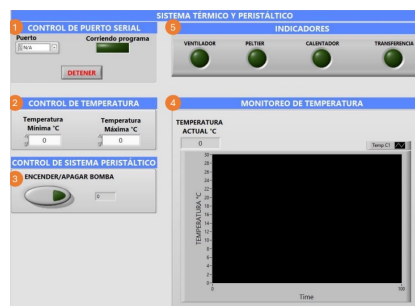
Figura 7. GUI para controlar y monitorear temperatura y sistema peristáltico
