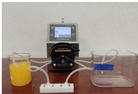
Figura 8. Prueba 1 en su estado inicial (100 RPM - 51 mL/min)
