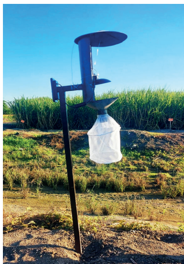
Figura 2. Trampa a base de una lampara adaptada a una fotocelda solar para la captura de insectos noctuidos (Noctuidae) en cultivos de caña del campo experimental “La Posta” perteneciente a la Unidad Académica Multidisciplinaria Mante - Centro, Ubicada en El Mante, Tamaulipas, México
