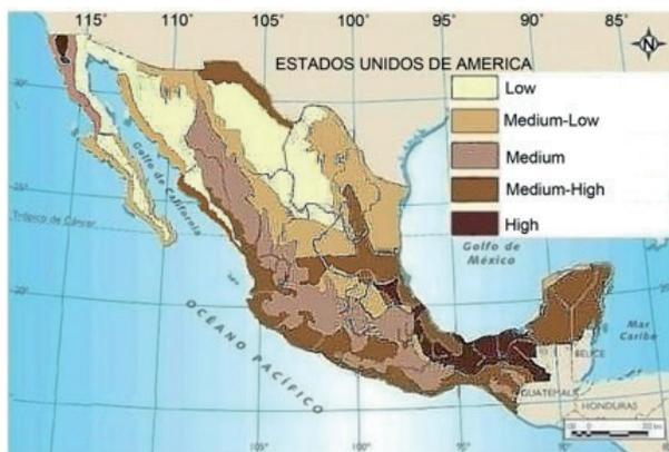
Figura 7. Clasificación del grado de corrosión atmosférica
