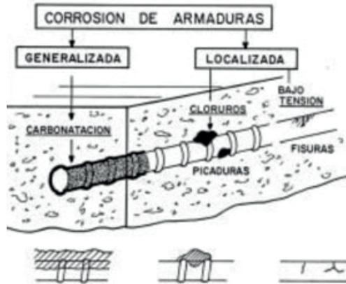
Figura 17. Tipología de la corrosión del acero de refuerzo en el concreto reforzado
