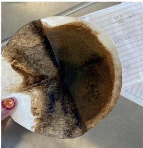
Figura 17. Precipitado 10 después de secarse en el horno para identificación de ion  $\text{Cu}^+$ .
