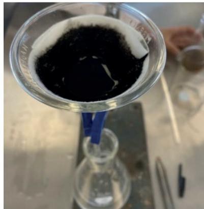
Figura 10. Resultado del precipitado 3 filtrado para identificación del catión  $\text{Hg}^+$
