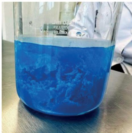
Figura 6. Resultado de la reacción para la identificación de  $\text{Cu}^{+2}$
