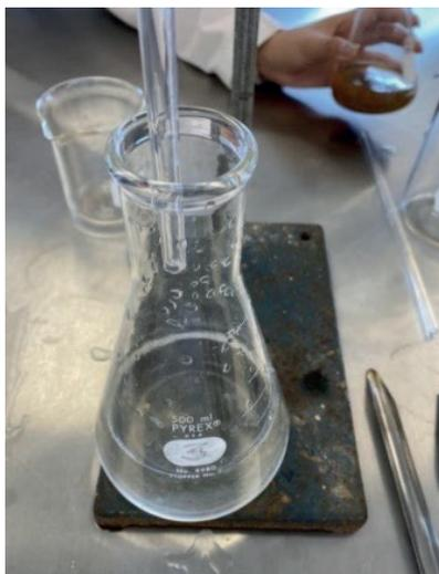
Figura 11. Ejemplo de cuándo parar la filtración o la marcha: se muestra el agua sin ninguna precipitación, completamente cristalina
