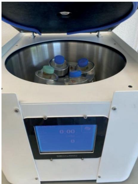
Figura 16. Proceso de centrifugación para separar el precipitado de la mezcla
