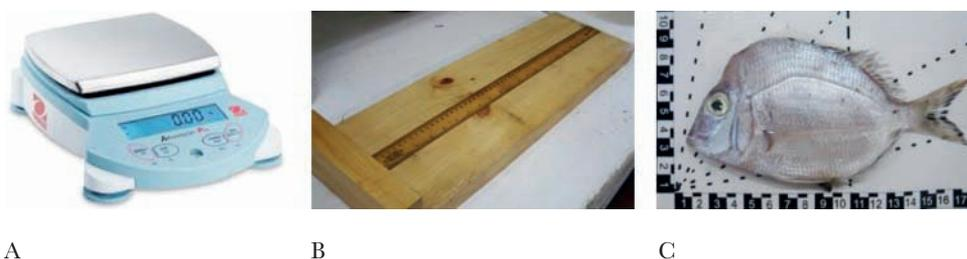
Figura 7. Balanza OHAUS (A), ictiómetro (B) y lona con escala (C)
