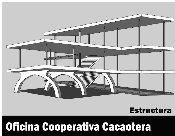
Fig 3. La propuesta de la oficina cacaotera, con la peculiaridad que las columnas (pilotis), se expresan por medio de arcos de medio punto. Fuente: Elaboración del autor
