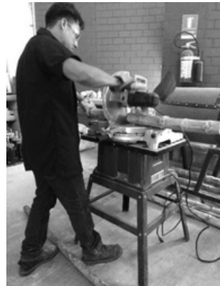
c) Corte para probetas para pruebas de compresión, cortante y de tablillas para tensión y prueba de absorción
