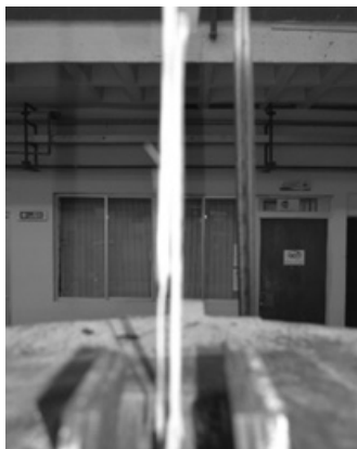
l) Falla por tensión paralela a la fibra en el tercio medio de la probeta
