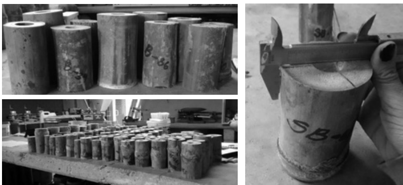
d) Corte de probetas para pruebas de compresión y cortante y medición para registro de diámetros
