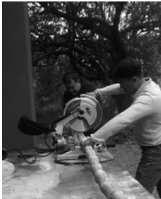
c) Corte para probetas para pruebas de compresión, cortante y de tablillas para tensión y prueba de absorción
