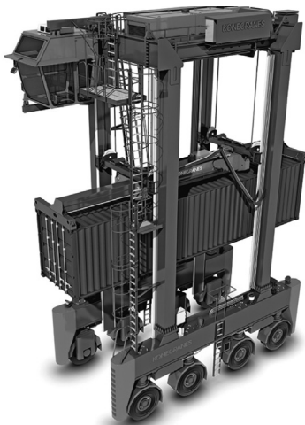
FIGURA II.2. Straddle Carrier. Fuente: www.konecranes.com
