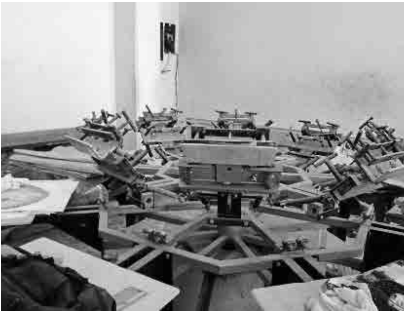
Foto 63: Máquina de sublimado. Esta tecnología desarrollada en Italia es la que actualmente algunos de los empresarios de Chiconcuac utilizan en la elaboración (impresión) de telas y de piezas acabadas.
